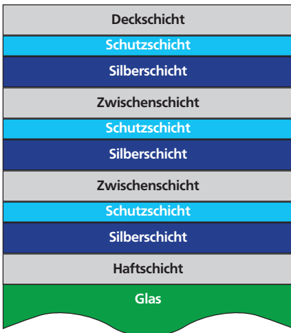
Schematische Darstellung einer 2-fach- bzw. 3-fach-Silber-Sonnenschutzbeschichtung
