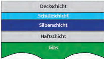
Schematische Darstellung einer Wärmedämmbeschichtung
